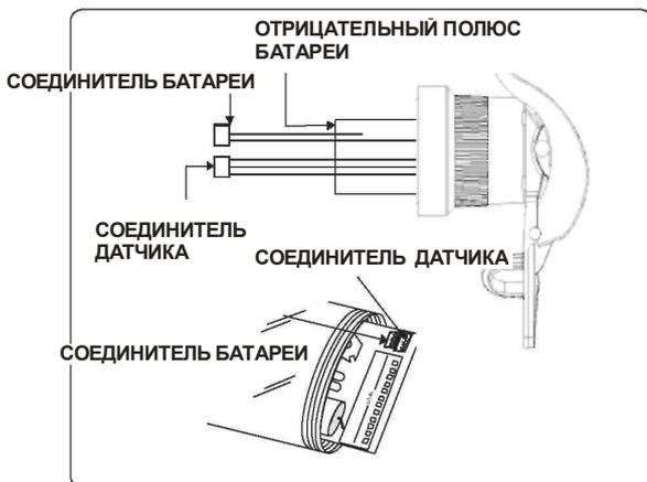
Рис. 10. Соединители LINETROLL 110Tμr
