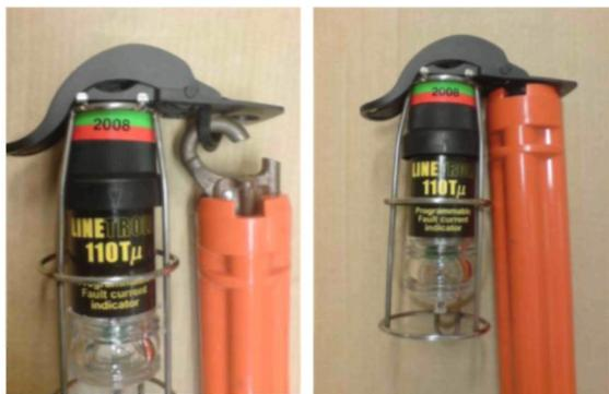
Рис. 14 Установка с помощью штанги – рядом с траверсой
