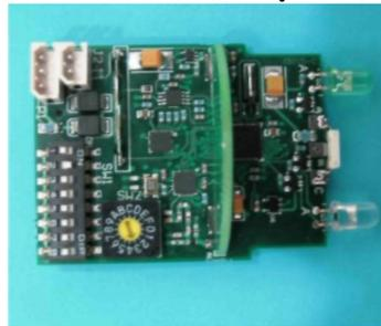
Рис. 11б. Поворотный переключатель в положении 0 для сброса счетчика батареи в индикаторе LineTroll 110Tμr.
